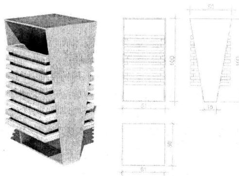
**3.3. Пейки с маса по спецификация** – изработени от три броя армирани фибробетонни елемента – два броя крака мита и един брой плот шлайфана мозайка, повърхностно обработени с UV и хидроизолационни лакове, предаващи мокър ефект върху бетоново-мозаечното изделие. Шест броя иглолистна дървесина-смърч, обработена с UV и хидроизолационен лак в широка цветова гама, запазващ естествената красота на дървесината.
